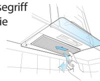
2 **FÜHREN SIE** beim Einbau des Fettfilters die Schritte in umgekehrter Reihenfolge aus.
