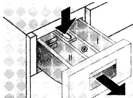
Die Waschmittelschublade ist in drei Kammern unterteilt
